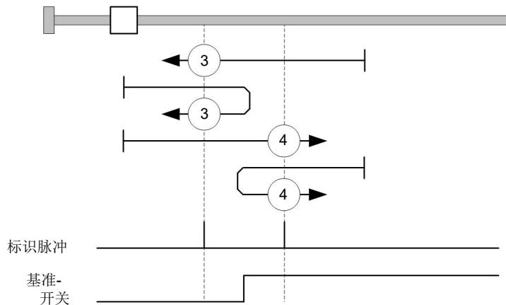
使用方法 5 和 6 时，将引用零位开关的右切换开关：
