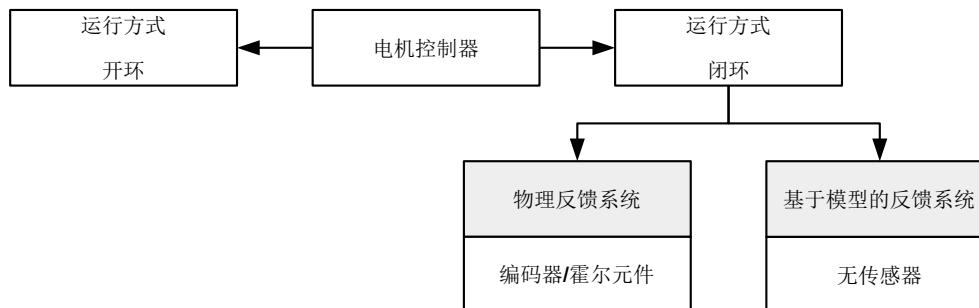
以下总结了电机技术相关的控制模式与反馈系统的所有可能的组合。对各个控制模式和反馈的支持情况因控制器而异，相关信息请参见引脚分配和**工作模式**章节。
