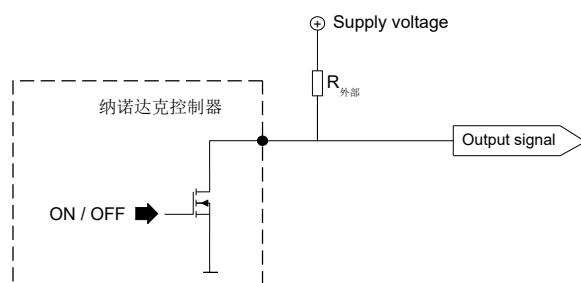
对于 +24 V 供电电压，建议使用电阻值  $R_{\text{外部}}$  10 k $\Omega$ 。
