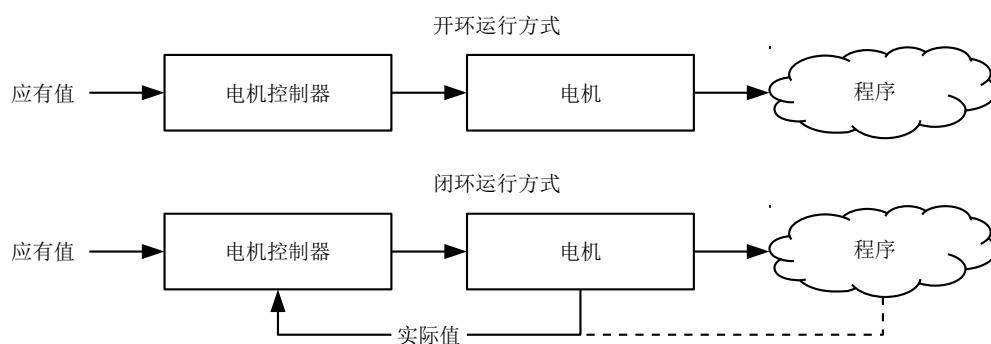
除物理反馈系统（如通过编码器或霍尔传感器）以外，还使用基于模型的反馈系统，统称为无传感器系统。这两种反馈系统也可组合使用，从而进一步提高控制质量。
