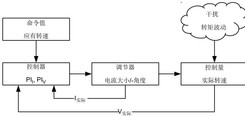
$PI_I$  = 比例-积分电流控制回路
