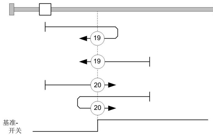
使用方法 21 和 22 (相当于方法 5 和 6) 时, 将引用零位开关的右切换开关:
