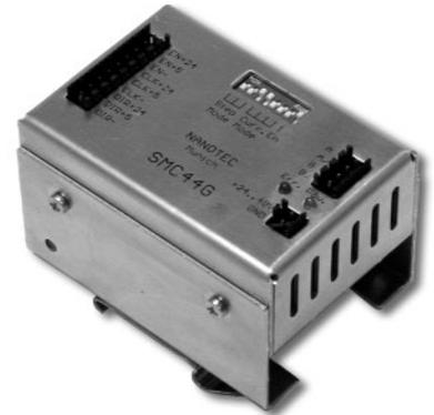
**Achtung:** An der Versorgungsspannung **muß** ein Ladekondensator von mind. 4.700 µF (Z-K4700/50) vorgesehen werden, damit beim Bremsvorgang die zul. Spannung nicht überschritten wird. Der Verpolungsschutz funktioniert nur, wenn das Netzteil einen Kurzschlußstrom von > 5 A liefert.
